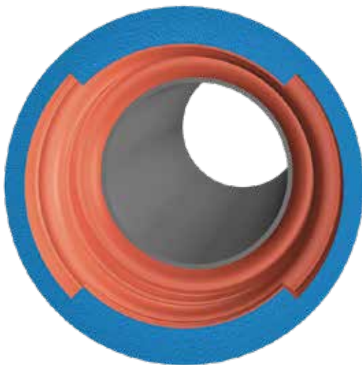
DN 300 till 500 monteras med fyra istället för två låselement, i motsvarande förankringsspår uppe och nere.
