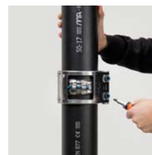
Växeldra de två bultarna med exempelvis en spärrnyckel. Monteringen är korrekt utförd när bultförbanden möts.
